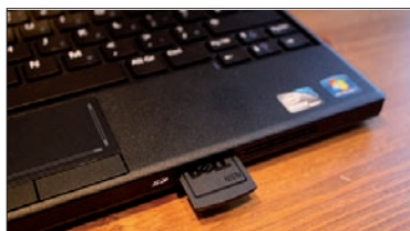
Rysunek 4.18. Miejsce w komputerze przenośnym do wpinania kart pamięci w celu zaimportowania plików
